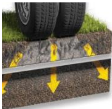
Hình 31. Hệ thống thảm cỏ tiên tiến (Netlon ATS) có khả năng chịu tải trọng xe nặng
