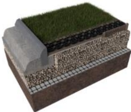
Hình 30. Bãi đỗ xe bằng cỏ kết hợp hệ thống gia cố cỏ (gạch lát cỏ bằng nhựa thấm nước)
